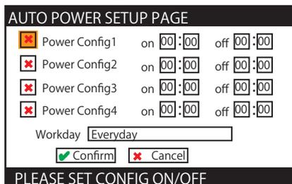
④リモコンの **◀ ▶** キーで Power Config 1 の on の” 時” の欄にカーソルを移動します。
