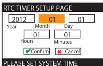
④リモコンの **◀ ▶** キーで変更する項目にカーソルを移動します。
